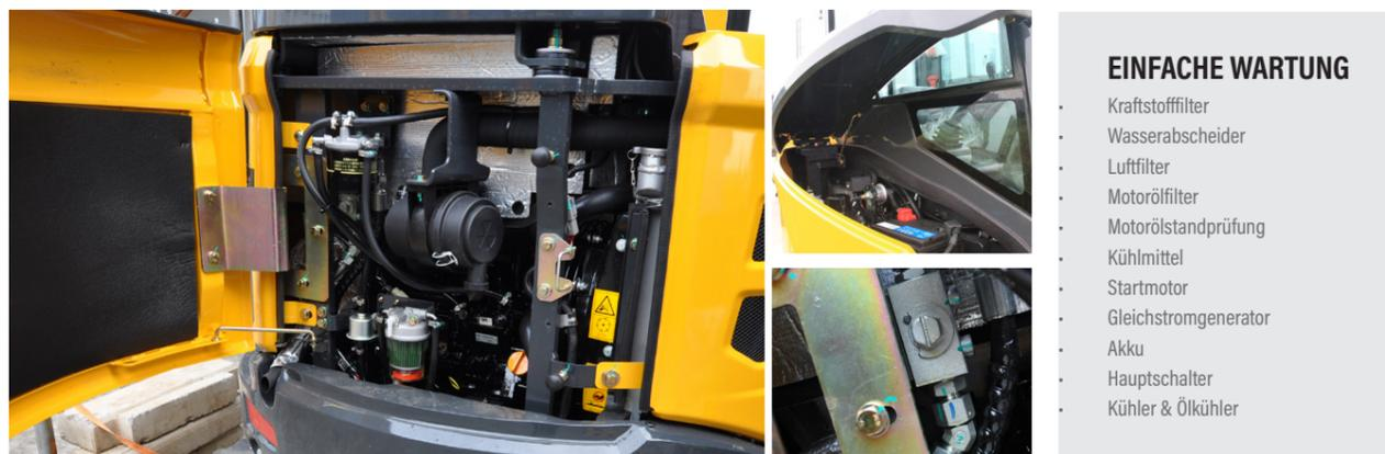
Der SE26SR/SE27SR wurde für niedrigere Wartungskosten und längere Serviceintervalle entwickelt, was zu einer höheren Verfügbarkeit der Maschine vor Ort führt. Außerdem stehen Ihnen erfahrene, von SHANTUI geschulte Techniker zur Verfügung, die Ihnen bei Bedarf zusätzliche Unterstützung bieten.
